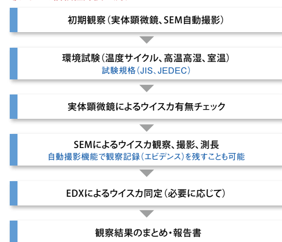
錫ウイスカ信頼性評価 (実装基板など大型の試料も観察できます)
