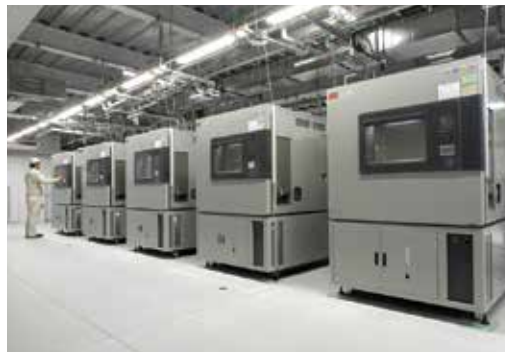
恒温恒湿器 (HIFLEX NEO) 試験室内寸法：W1000 × H1000 × D800 (mm)
