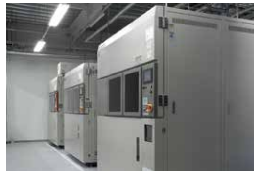
液槽式 熱衝撃試験器 (WINTECH NT) 試験室内寸法：W220 × H220 × D310 (mm)
