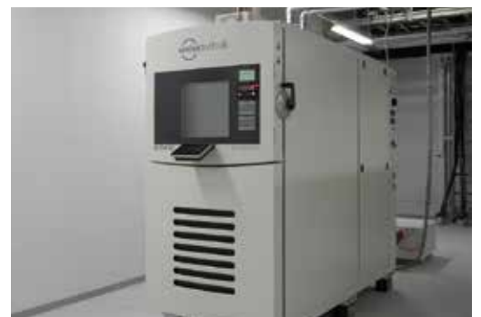
試料移動型 熱衝撃試験 試験室内寸法：W470 × H410 × D650 (mm)
