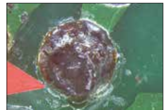
HALT 試験後のはんだ不良箇所
