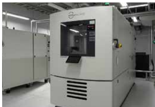
ハイパワー急速温度変化試験器 試験室内寸法：W1100 × H950 × D1325 (mm)
