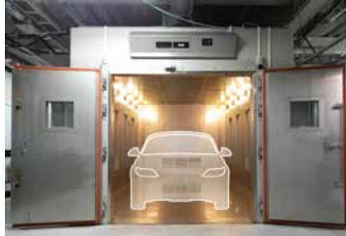
大型環境試験室 試験室内寸法：W4600 × H2300 × D3470 (mm)
