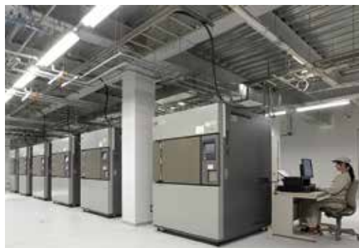
気槽式 温度サイクル試験器 (WINTECH) 試験室内寸法：W650 × H500 × D400 (mm)
