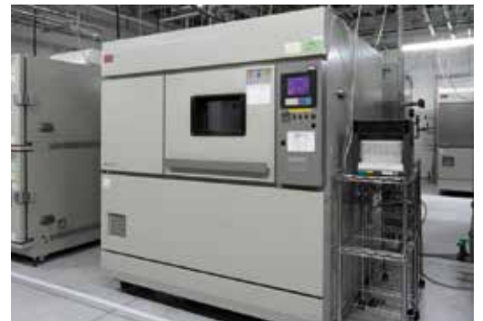
結露サイクル試験器 (DEW CYCLE) 試験室内寸法：W650 × H500 × D400 (mm)
