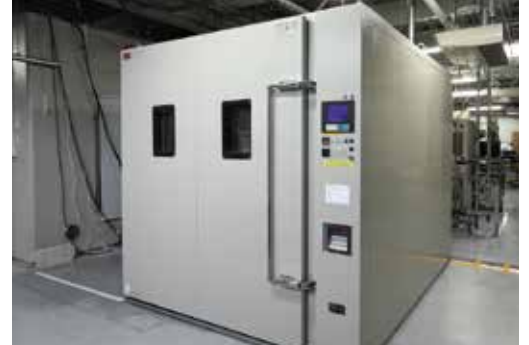
大型恒温恒湿装置 試験室内寸法：W1500 × H1800 × D1500 (mm)
