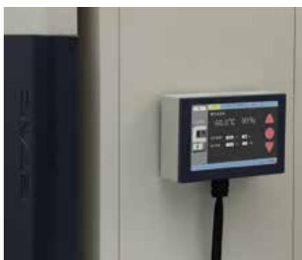
HIFLEX用に開発された液晶タッチパネル式のキーパッドです。コンスタント運転やプログラム運転の詳細な設定、試験条件のインポート・エクスポート、試験データのダウンロードなどの多くの機能を持ちながら、分かりやすく洗練された操作を可能にしています。
