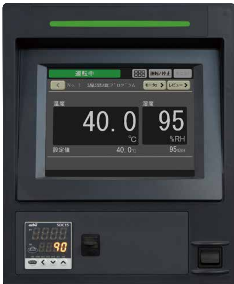
槽内モニタ画面
